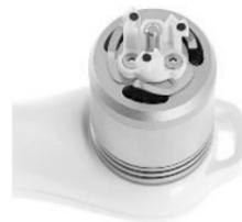
Imagen 12: Sistema de propulsión del DJI Phantom 4 pro. Fuente: Elaboración propia.
