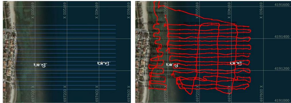
Imagen 2: Líneas de navegación programadas en Hypack (izquierda) y líneas observadas en campo (derecha) en playa del Mojón (Pilar de la Horadada). Fuente: Elaboración propia.
