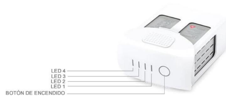
Imagen 11: Batería del DJI Phantom 4 pro. Fuente: Elaboración propia.
