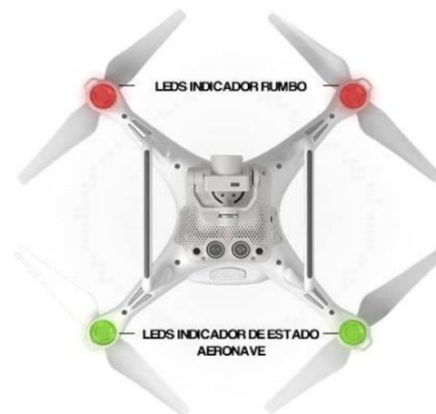
Imagen 16: Indicadores leds del DJI Phantom 4 pro. Fuente: Elaboración propia.
