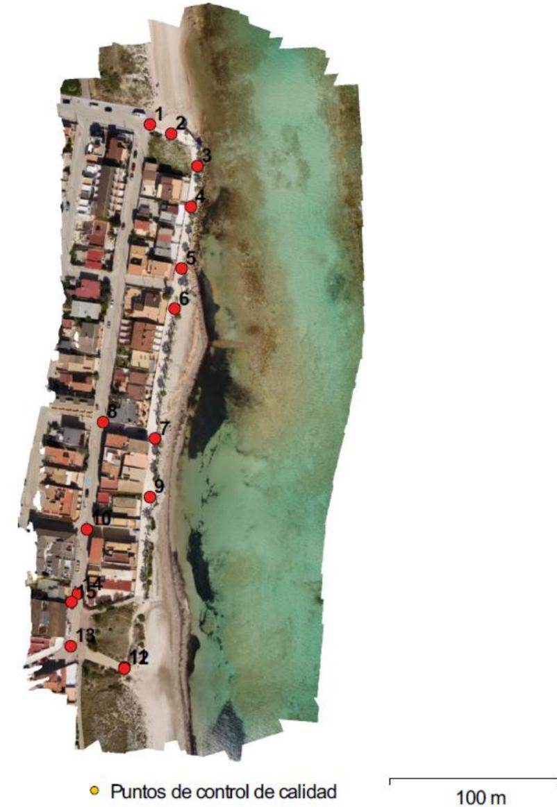
Imagen 19: Puntos de calibración terrestre. Fuente: Elaboración propia.
