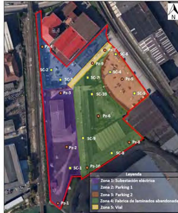
Los trabajos de campo han incluido la realización de un total de 20 puntos de muestreo, en concreto 10 sondeos cortos para muestreo de suelo y 10 sondeos con instalación de piezómetro con el objetivo de muestrear también aguas subterráneas. La ubicación final de los puntos de muestreo ha sido esencialmente el mismo que el planteado en el plan de muestreo.
