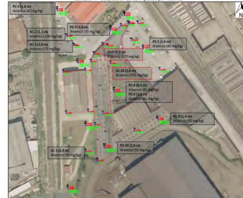
Además, se ha observado que existe una afección en varios puntos por TPH (hidrocarburos del petróleo) siendo los más relevante en el punto SC-4 ubicado en la zona de Parking 2 y sobre todo los puntos SC8 y SC10 ubicados en el interior de la fábrica de laminados.
