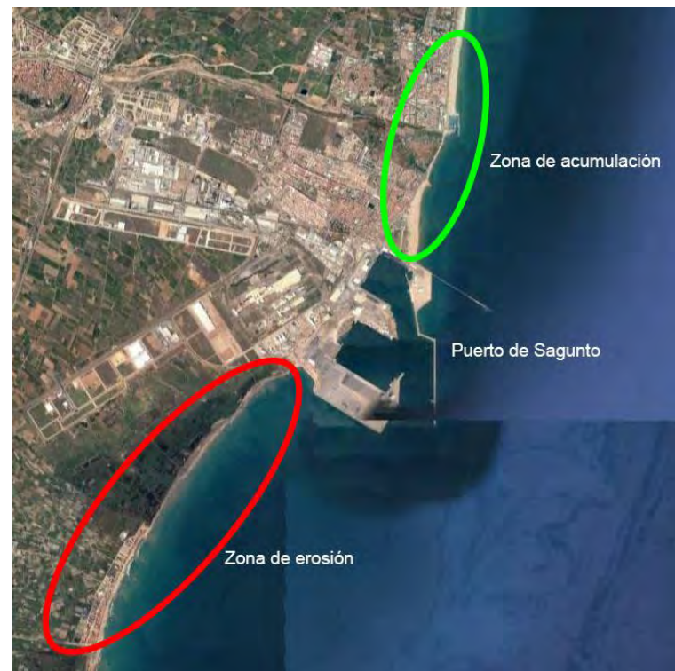
Figura 12. Zonas de erosión y acumulación de sedimentos en el entorno del Puerto de Sagunto.
