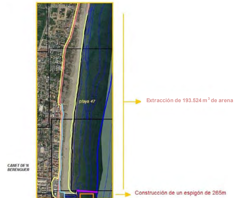
Figura 4. Actuaciones propuestas en la playa de Canet (Fuente: Estudio Integral de Alternativas, IH Cantabria, 2.011)
