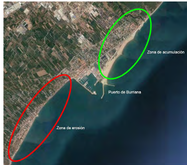
Figura 11. Zonas de erosión y acumulación en el entorno del Puerto de Burriana.
