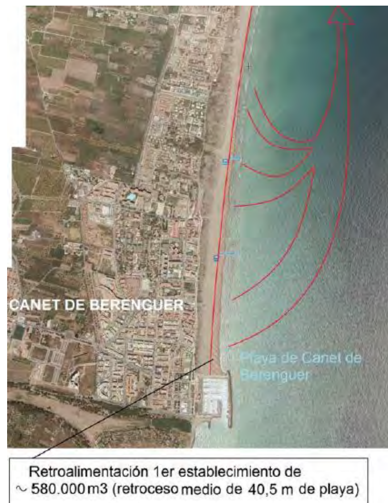
Figura 7. Propuesta de retroalimentación con arena procedente de la playa de Canet (Fuente: Estrategia de Actuación entre Puertos de Castellón y Sagunto, CEDEX, 2015)
