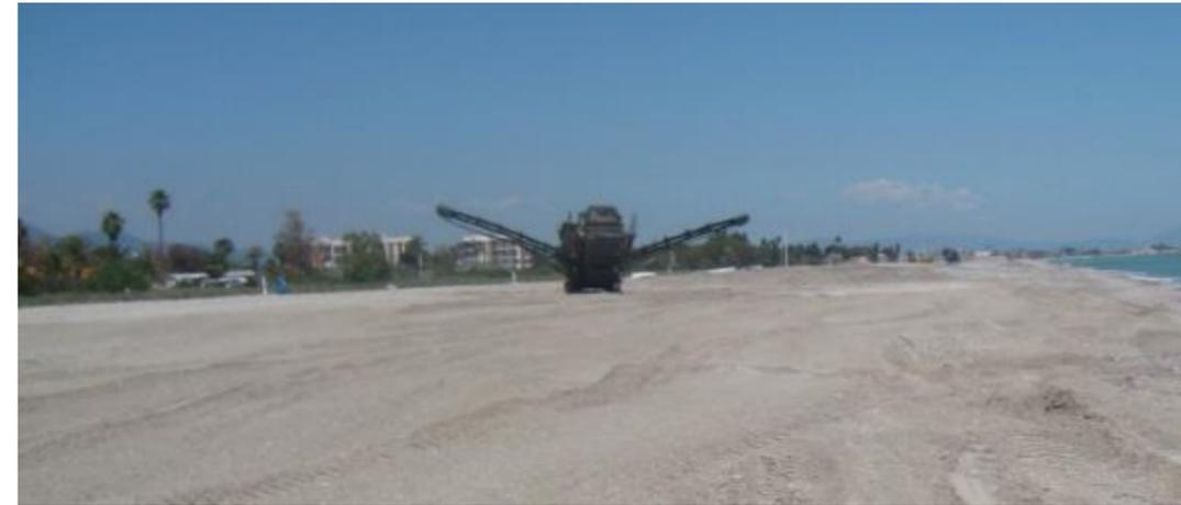
Figura 23. Cribadora móvil utilizada para la gestión de gravas en la zona de proyecto. Fuente: Demarcación de Costas en Valencia, 2020.
