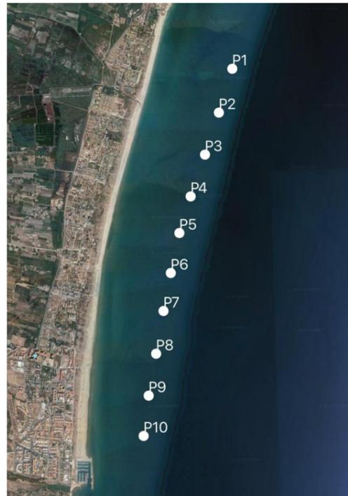
Figura 3. Puntos de control para la reconstrucción de la serie temporal de oleaje en la zona de interés.
