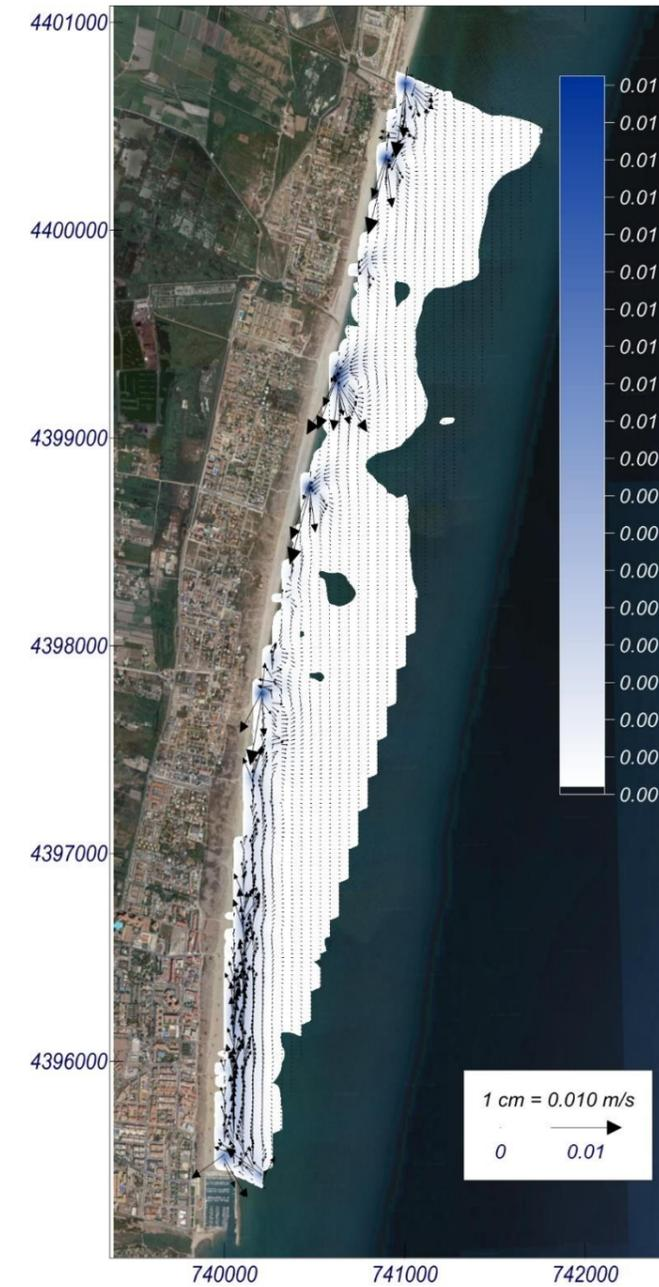
Figura 41. Corrientes de rotura asociadas a la propagación de un oleaje medio de Dirección ESE, Hs 0,32m y Tp 5s. Situación futura. Año 2.045.
