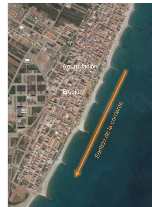
Figura 6. Ejemplo de playa rigidizada mediante espigones, en Moncófar 9 km al norte de la zona de actuación.
