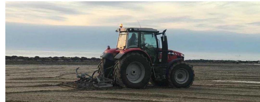
Figura 6. Aireado de arenas con arado.
