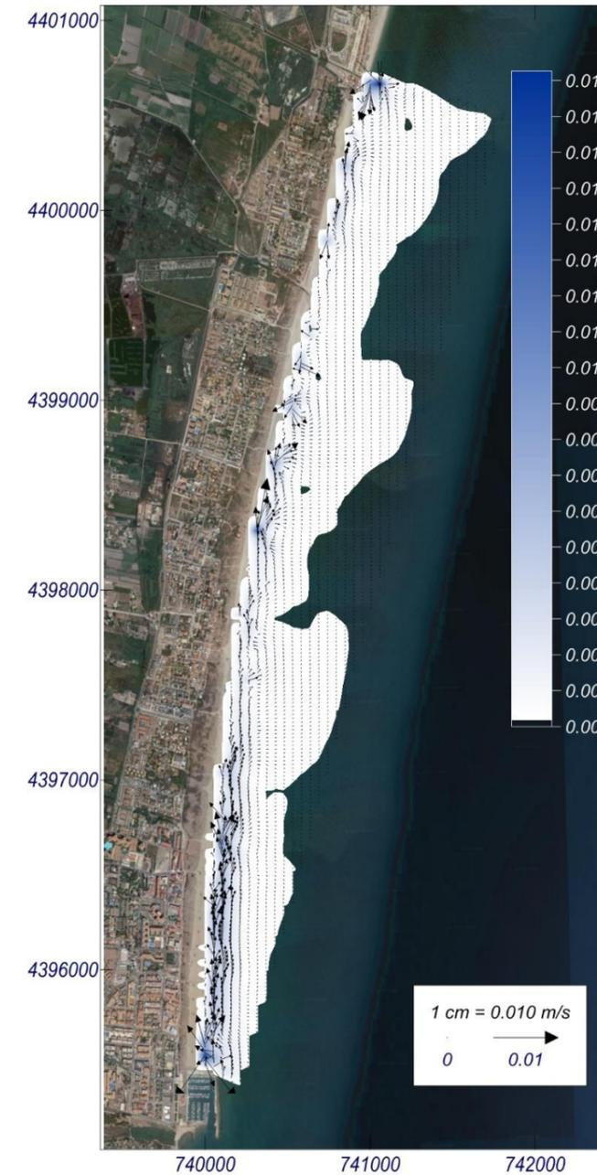
Figura 8. Corrientes de rotura asociadas a la propagación de un oleaje medio de Dirección ESE, Hs 0,32m y Tp 5s. Horizonte 2.
