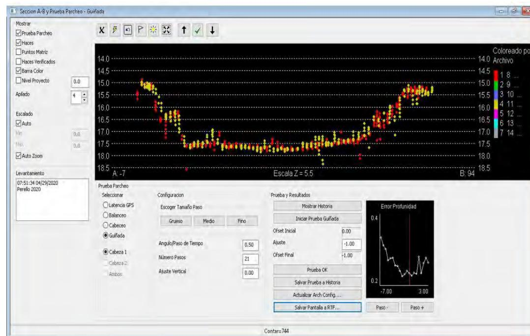
Figura 15. Prueba Parcheo: Guiñada. Cabeza sonar: Cabeza 1.
