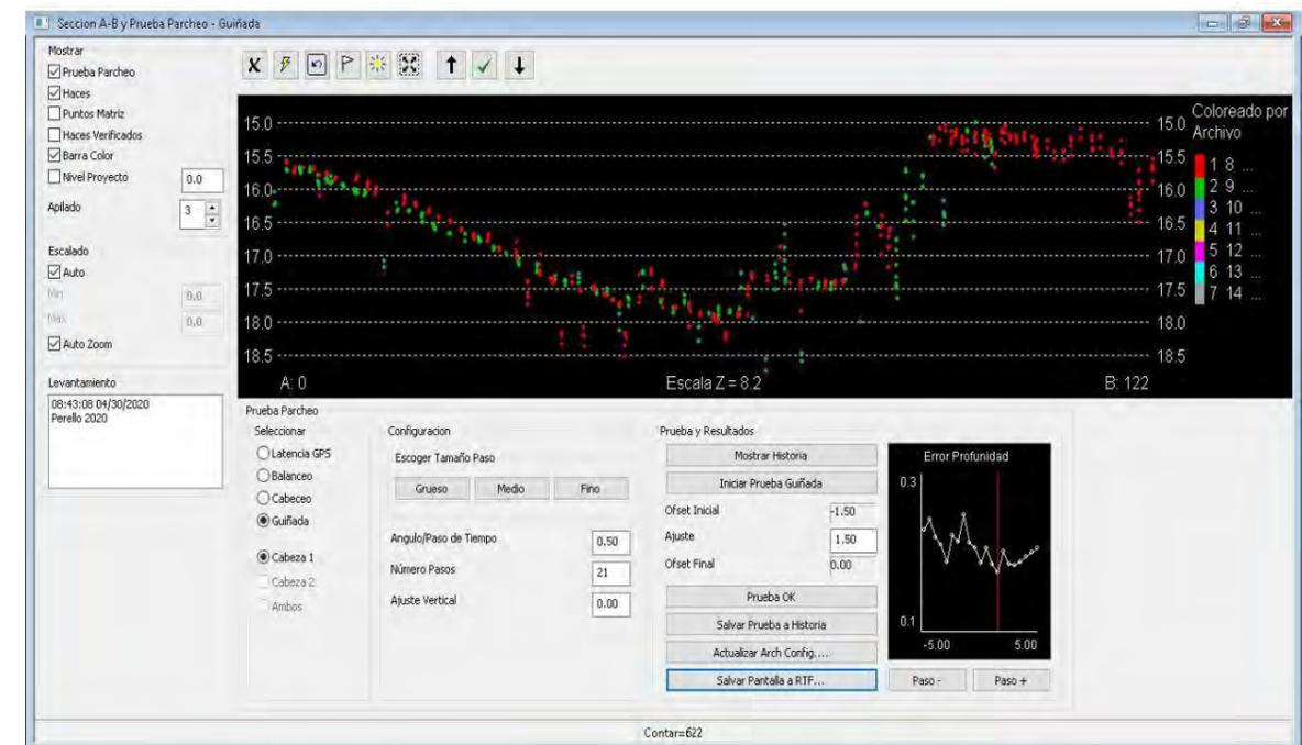
Figura 24. Prueba Parcheo: Guiñada. Cabeza sonar: Cabeza 1.
