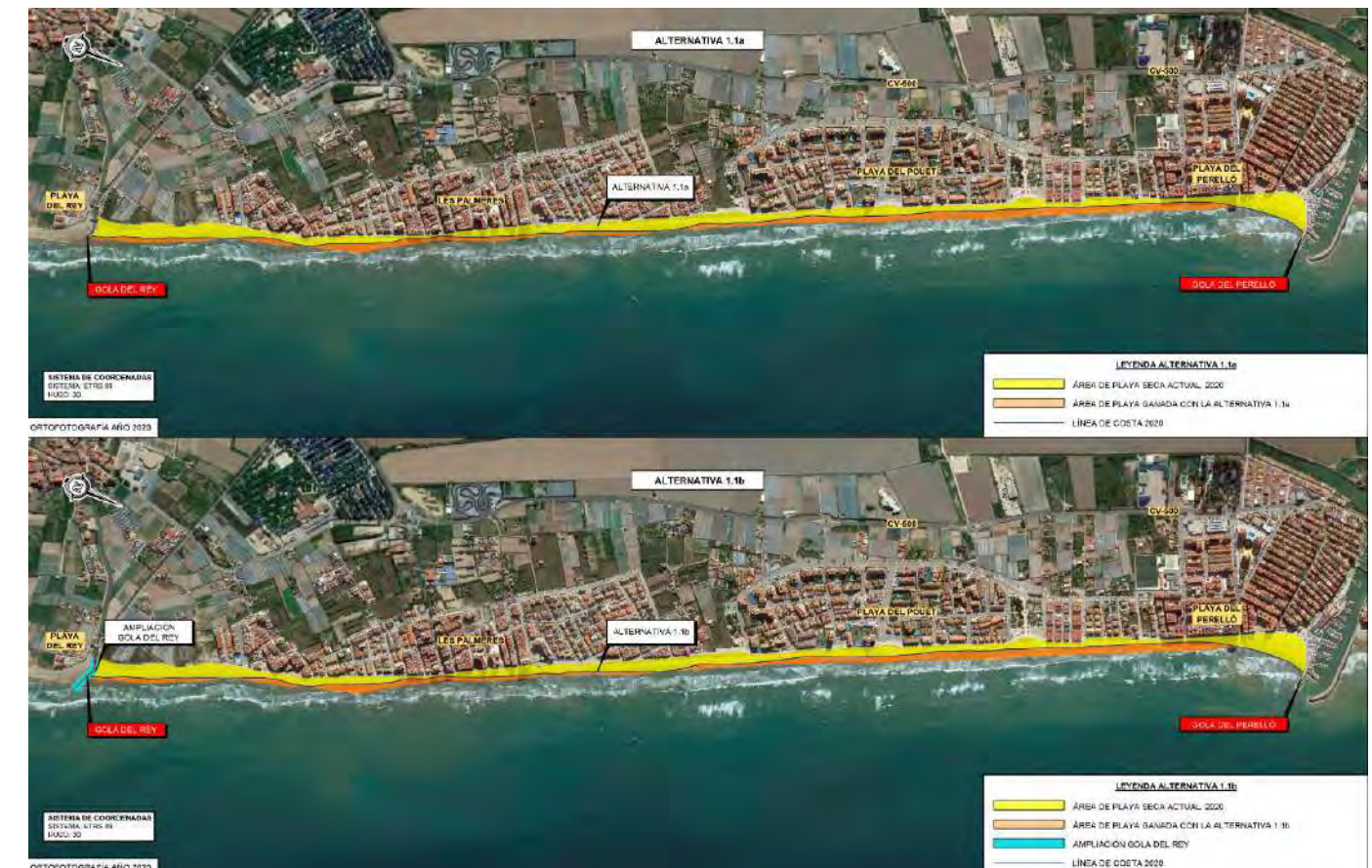
Figura 4. Subalternativas 1.1.a (superior) y 1.1.b (inferior). El área marcada en amarillo corresponde a la playa seca actual (2020), y la marcada en naranja a la ganancia de playa seca debida a la alternativa.
