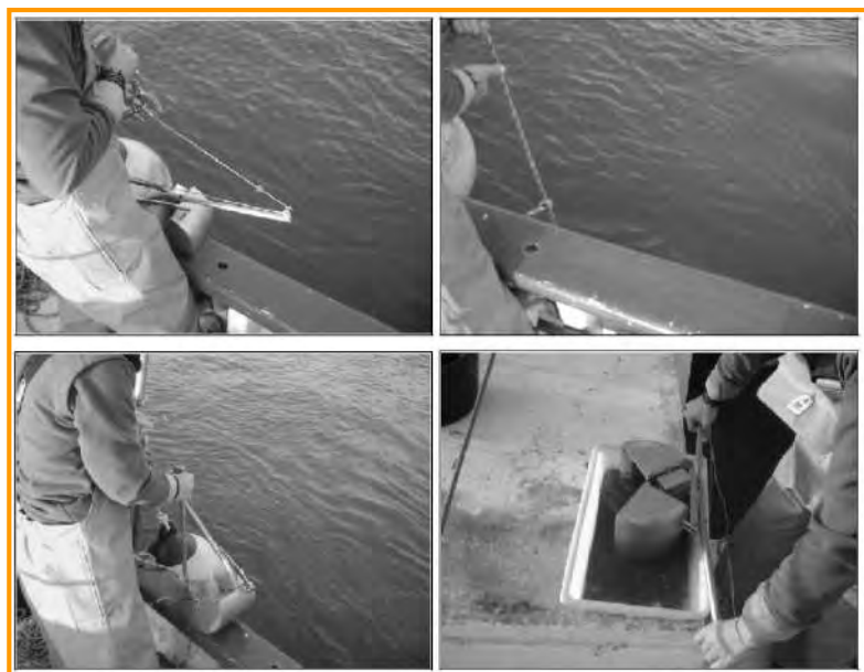
Figura 11. Imágenes del proceso de toma de muestras mediante draga Van Veen.
