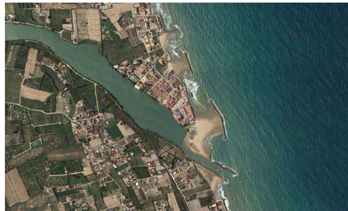
Figura 5. Vista aérea de diques exentos en la playa de L'Estany, Cullera, Valencia.
