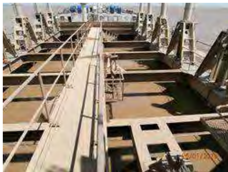
Figura 10. Cántara de la draga de succión por arrastre llena
