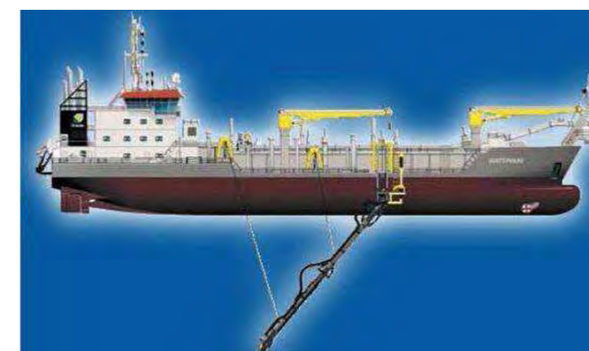
Figura 6. Draga de succión en marcha
